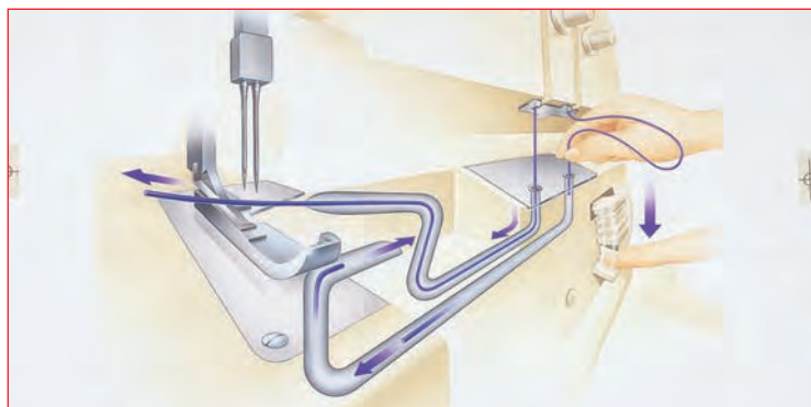
Overlockový steh se 4 nitěmi je robustní steh na začišťování a sešívání veškerých materiálů, zvláště pružných látek.
